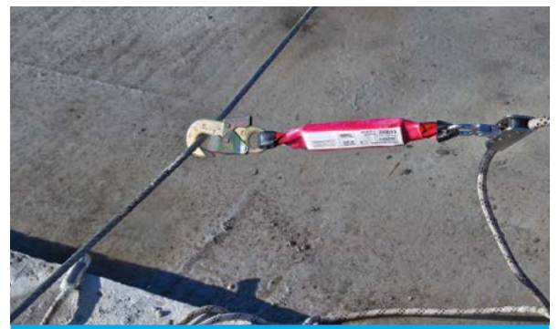
Анкерування до лінійної напрямної, що використовується відповідно до інструкцій виробника.
